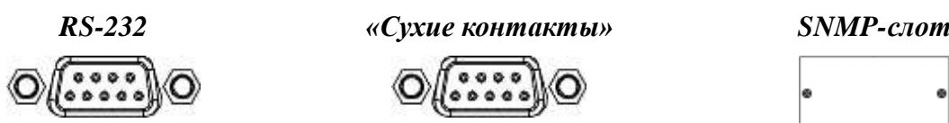
Для осуществления мониторинга и управления ИБП подключите соответствующие кабели к портам RS-232, "Сухие контакты" или к SNMP-адаптеру.
