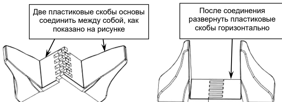
Рисунок 4 - Сборка пластиковых основ для вертикальной установки изделия.
