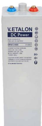
OPzV - это герметичный аккумулятор с клапаном для регулирования газовыделения. В нём используется гелеобразный электролит и трубчатые положительные пластины. Благодаря гелеобразному электролиту аккумулятор устойчив к глубокому разряду и имеет увеличенный ресурс при циклическом использовании.
