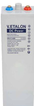
OPzV - это герметичный аккумулятор с клапаном для регулирования газовыделения. В нём используется гелеобразный электролит и трубчатые положительные пластины. Благодаря гелеобразному электролиту аккумулятор устойчив к глубокому разряду и имеет увеличенный ресурс при циклическом использовании.
