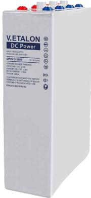
OPzV - это герметичный аккумулятор с клапаном для регулирования газовыделения. В нём используется гелеобразный электролит и трубчатые положительные пластины. Благодаря гелеобразному электролиту аккумулятор устойчив к глубокому разряду и имеет увеличенный ресурс при циклическом использовании.
