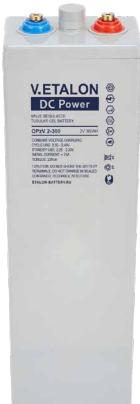
OPzV - это герметичный аккумулятор с клапаном для регулирования газовыделения. В нём используется гелеобразный электролит и трубчатые положительные пластины. Благодаря гелеобразному электролиту аккумулятор устойчив к глубокому разряду и имеет увеличенный ресурс при циклическом использовании.
