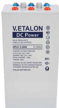
OPzV - это герметичный аккумулятор с клапаном для регулирования газовыделения. В нём используется гелеобразный электролит и трубчатые положительные пластины. Благодаря гелеобразному электролиту аккумулятор устойчив к глубокому разряду и имеет увеличенный ресурс при циклическом использовании.
