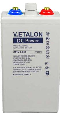
OPzV - это герметичный аккумулятор с клапаном для регулирования газовыделения. В нём используется гелеобразный электролит и трубчатые положительные пластины. Благодаря гелеобразному электролиту аккумулятор устойчив к глубокому разряду и имеет увеличенный ресурс при циклическом использовании.
