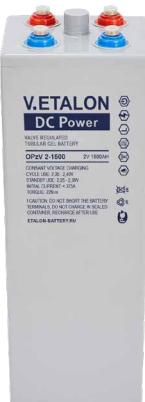
OPzV - это герметичный аккумулятор с клапаном для регулирования газовыделения. В нём используется гелеобразный электролит и трубчатые положительные пластины. Благодаря гелеобразному электролиту аккумулятор устойчив к глубокому разряду и имеет увеличенный ресурс при циклическом использовании.
