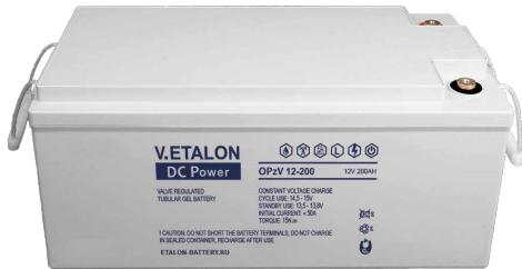
OPzV - это герметичный аккумулятор с клапаном для регулирования газовыделения. В нём используется гелеобразный электролит и трубчатые положительные пластины. Благодаря гелеобразному электролиту аккумулятор устойчив к глубокому разряду и имеет увеличенный ресурс при циклическом использовании.
