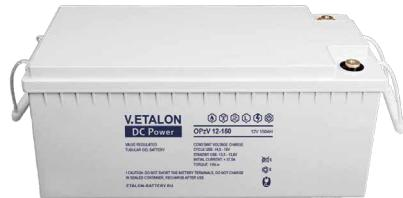
OPzV - это герметичный аккумулятор с клапаном для регулирования газовыделения. В нём используется гелеобразный электролит и трубчатые положительные пластины. Благодаря гелеобразному электролиту аккумулятор устойчив к глубокому разряду и имеет увеличенный ресурс при циклическом использовании.
