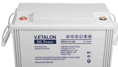
OPzV - это герметичный аккумулятор с клапаном для регулирования газовыделения. В нём используется гелеобразный электролит и трубчатые положительные пластины. Благодаря гелеобразному электролиту аккумулятор устойчив к глубокому разряду и имеет увеличенный ресурс при циклическом использовании.
